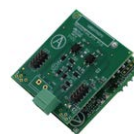
Pasarelas de aerotermia
