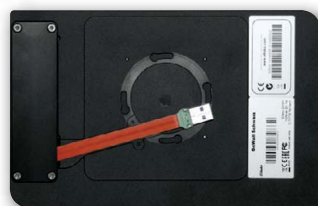
Parte trasera conector USB-A
