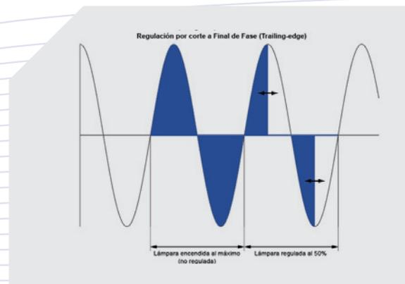
Compatible con cargas tipo R, L y C: incandescencia, halógenas 230V, halógenas con transformador ferromagnético o electrónico, Lámparas LED 230V y Lámparas LED 12V con transformador electrónico.
