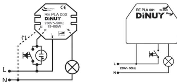
(\*) Instalación del Neutro opcional. Necesario con cargas muy inductivas (transformadores toroid)
