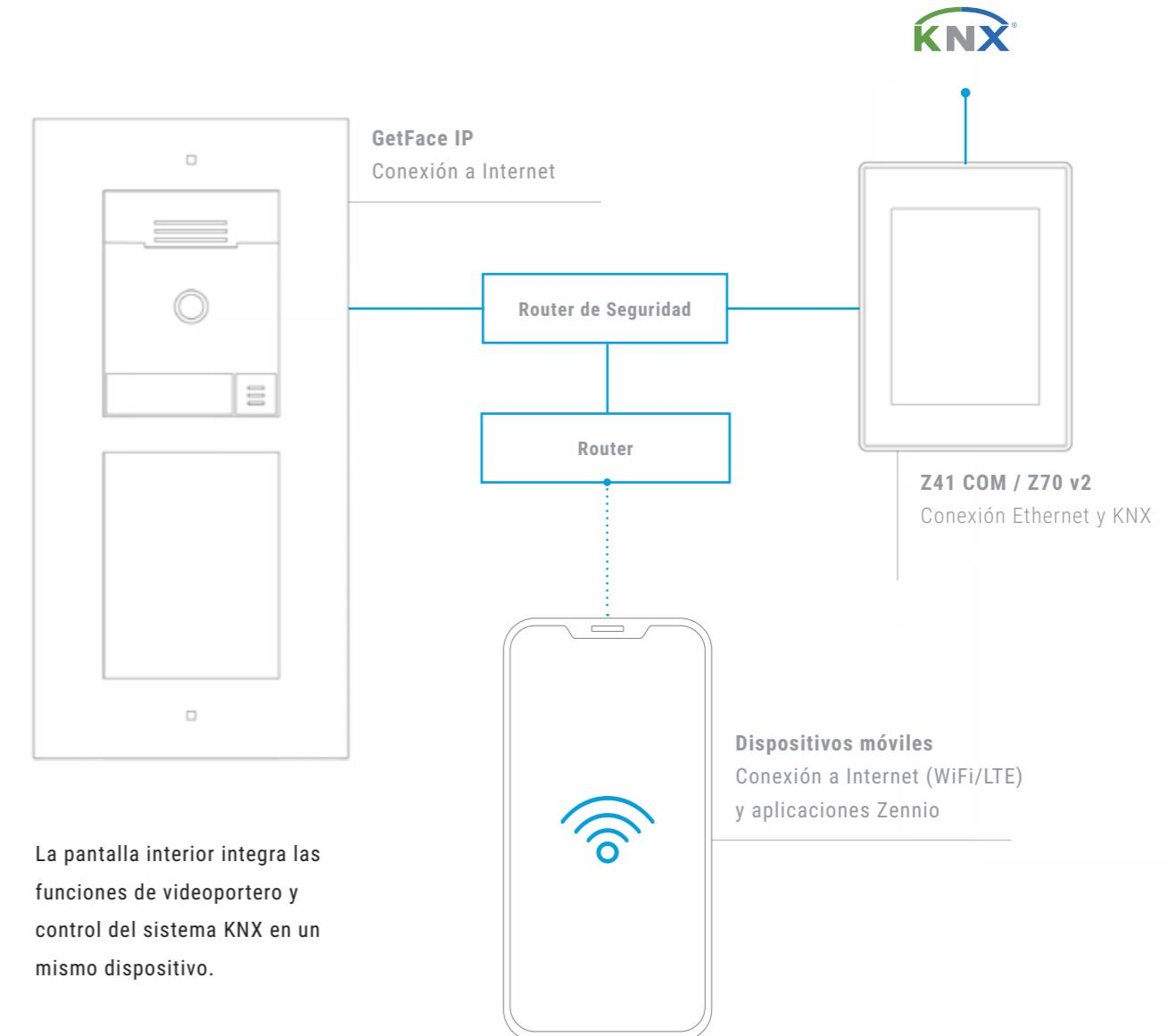
La pantalla interior integra las funciones de videoportero y control del sistema KNX en un mismo dispositivo.
