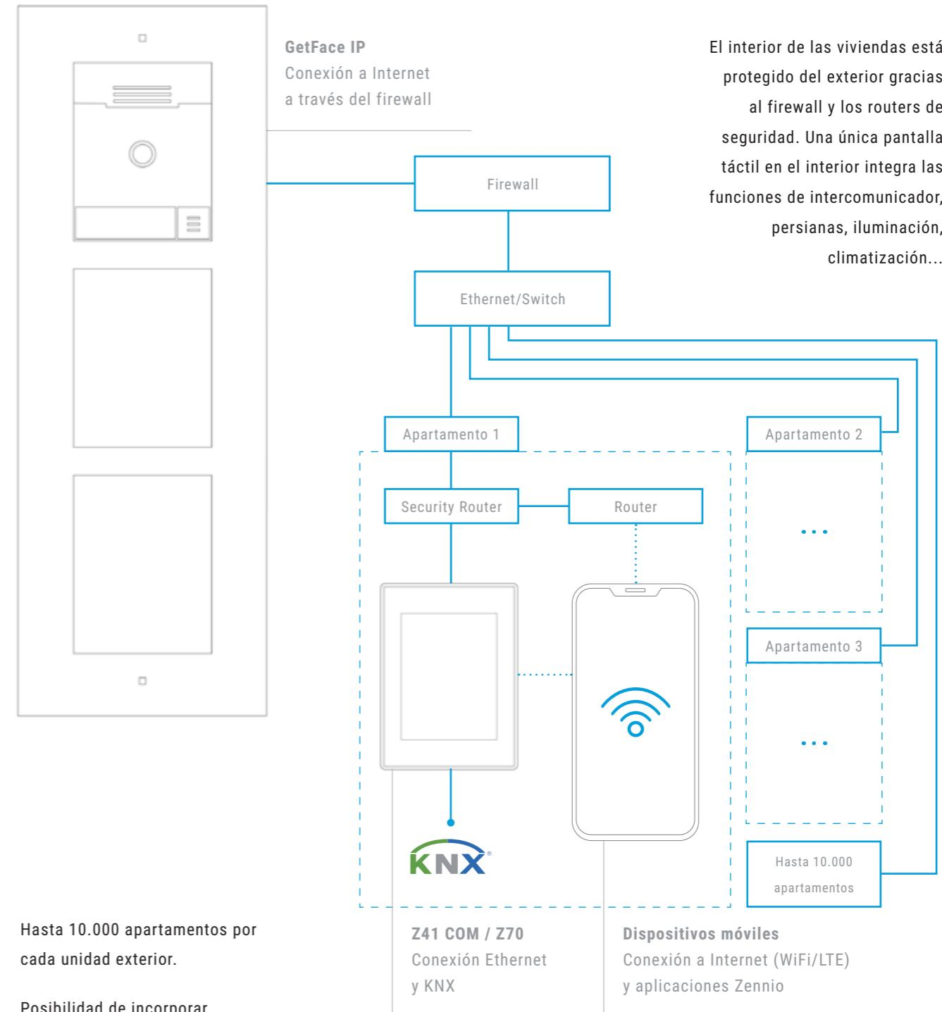
El interior de las viviendas está protegido del exterior gracias al firewall y los routers de seguridad. Una única pantalla táctil en el interior integra las funciones de intercomunicador, persianas, iluminación, climatización...
