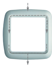
Recorrido de evacuación del agua que entra entre tecla y marco-soporte tecla.
