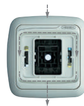
Recorrido de evacuación del agua que entra entre marco y marco-soporte tecla.
