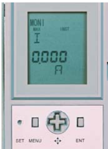
Tipo 2 Relé estándar con pantalla LCD -Amperímetro.
