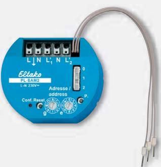
**Powerline-actuador-persiana para 1 motor. 53x43 mm, 25 mm de profundidad, para el montaje en cajas de mecanismos de 58 mm. Contacto NA para motores hasta 3A. 2 entradas para sensores con bajo voltaje interna. Pérdida Stand-by solo 0,5 vatios. Para el control y la comutación en el mismo lugar.**
