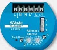
**Powerline-actuador TLZ con 1 canal. 53x43 mm, 25 mm de profundidad, para el montaje en cajas de mecanismos de 58 mm. Retardo en desconexión de 1 minuto hasta 120 minutos. Aviso de desconexión opcional. 1 contacto NA no libre de potencial 10A/250V AC, lámparas incandescentes 2000 Vatios. Entradas de sensores 230V. Pérdida Stand-by solo 0,5 vatios. Para el control y la commutación en el mismo lugar.**
