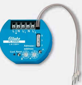
**Powerline-actuador de 2 canales. 53x43mm, 25 mm de profundidad, para el montaje en cajas de mecanismos de 58 mm. Utilizable como telerruptor o relé. 1+1 contacto NA no libre de potencial 5 A/250 V AC, lámparas incandescentes 1000 vatios. 2 entradas para sensores con bajo voltaje interno. Pérdida Stand-by solo 0,5 vatios. Para el control y la commutación en el mismo lugar.**
