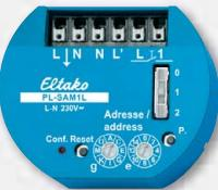
**Powerline actuador de 1 canal. 53x43mm, 25 mm de profundidad, para el montaje en cajas de mecanismos de 58 mm. Utilizable como telerruptor o relé. 1 contacto no libre de potencial 10 A/250 V AC, lámparas incandescentes hasta 2000 W. Entrada para sensores de 230 V. Pérdida Stand-by solo 0,5 vatios. Para el control y la commutación en el mismo lugar.**
