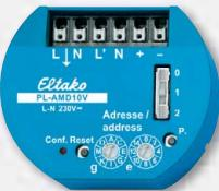
**Powerline-actuador regulación 1-10V. 53x43 mm, 25 mm de profundidad, para el montaje en cajas de mecanismos de 58 mm. Para la conmutación y/o regulación con interface de 1-10 V. 1 contacto NA no libre de potencial de 600 VA. Pérdida Stand-by solo 0,5 vatios. Para el control y la regulación por distintos lugares.**
