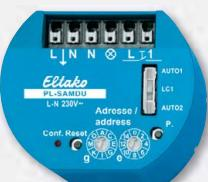
**Powerline-Dimmer-universal. 53x43 mm, 40 mm de profundidad, para el montaje en cajas de mecanismos de 58 mm. Power MOSFET hasta 300W. Reconocimiento automático de lámparas. Entrada de sensores 230 V. Pérdida Stand-by solo 0,6 vatios. Para el control y la regulación en el mismo lugar.**
