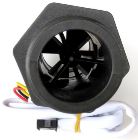
Figura 3. Sensor IoT de caudal de agua, DN 50.
