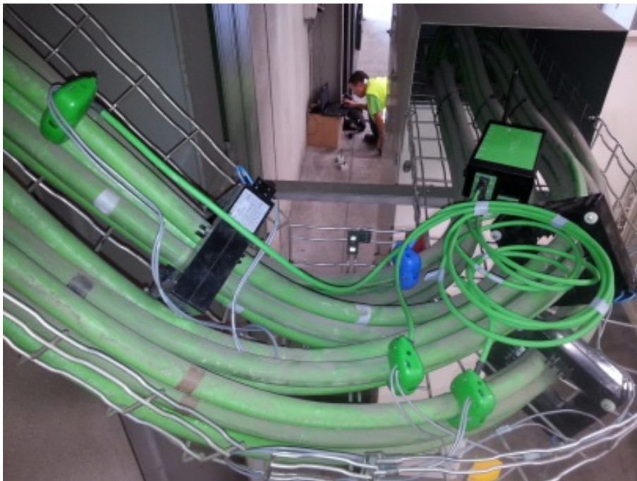
Figura 1. CYSMETER montado en una instalación y aspecto de la pinza voltimétrica, mostrando el punzón para el contacto eléctrico, que mide la forma de onda de las tensiones.
