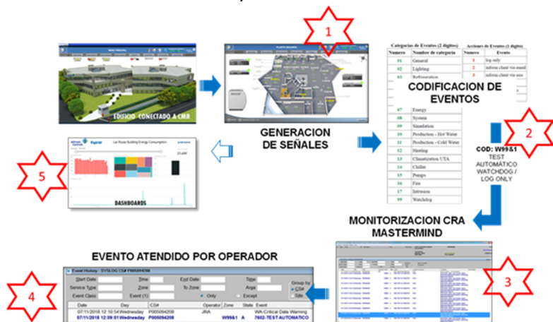
Figura 11. Flujo de funcionamiento de la generación, envío y gestión de señales desde el sistema Metasys de un edificio a la CRA.
