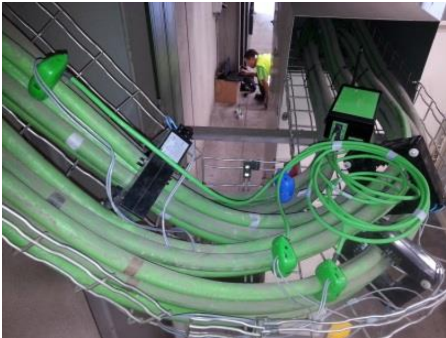
Figura 1. CYSMETER montado en una instalación y aspecto de la pinza voltimétrica, mostrando el punzón para el contacto eléctrico, que mide la forma de onda de las tensiones.
