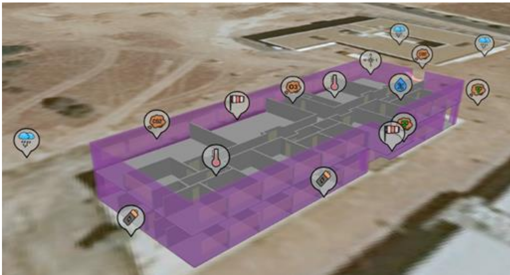
Figura 2. Edificio ITSI - Modelado 3D con sensores.
