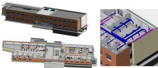
Figura 3. Modelo BIM del Edificio Gestión de Móstoles.
