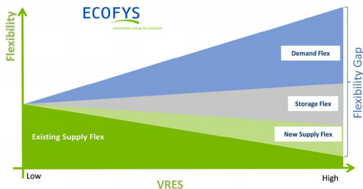
Figura 1. Brecha en la flexibilidad en el Sistema eléctrico Europeo con diferentes penetraciones de renovables no gestionables (EUROELECTRIC, 2014).
