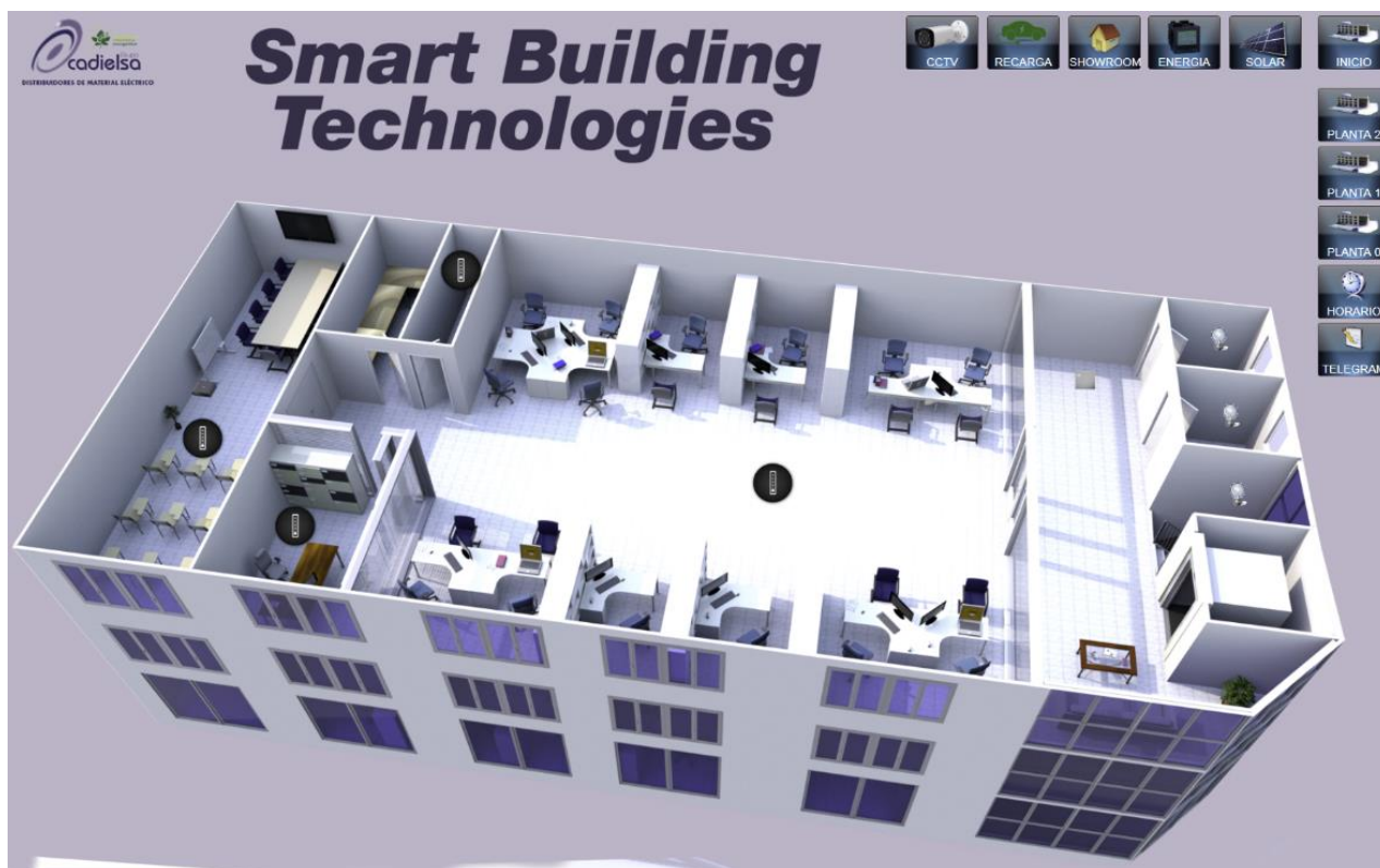
Figura 5. Imagen 3D control clima planta 2ª en BMS.
