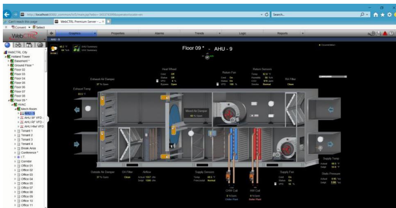
Figura 4. Ejemplo de gráfico de control de un climatizador desde el BMS -WebCTRL de Automated Logic.
