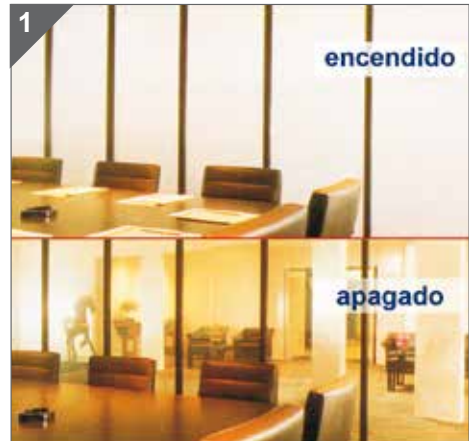
Ventanas inteligentes: se coloca una película de cristal líquido entre los cristales.
