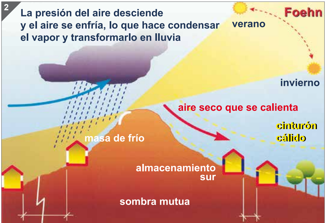
Influencia del paisaje: efecto foehn en las laderas norte y sur de una montaña.
