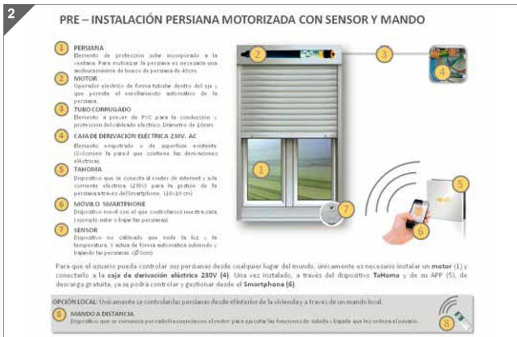
Pre-instalación de sistema automático del control solar.
