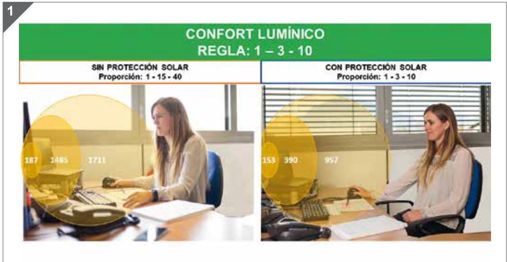
Regla 1-3-10 para evitar deslumbramiento y cambios bruscos de niveles de iluminación en la sala.
