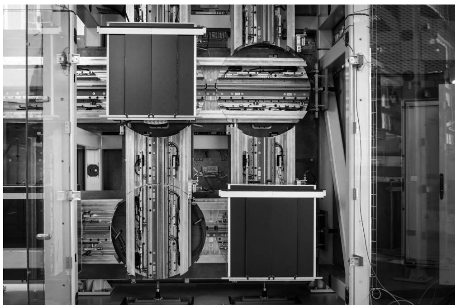
Figura 4. Tecnología de motores lineales de MULTI.
