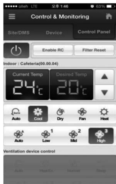
Figura 3. Pantalla de Control local de una Bomba de Calor.
