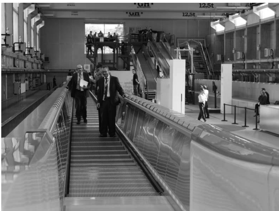
Figura 2. Pasillo de aceleración ACCEL instalado en el laboratorio de thyssenkrupp Elevator Innovation Center.
