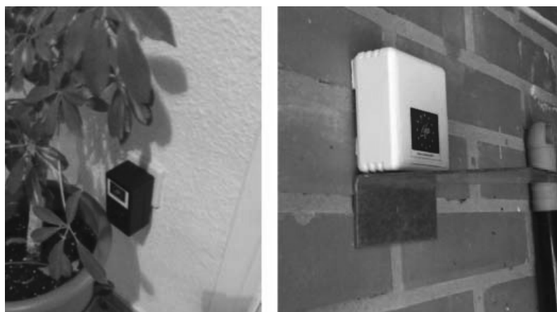
Figura 6. La instalación del sensor de confort interior consiste en enchufar el sensor directamente en un enchufe (la señal se envía inalámbricamente). La instalación del sensor de confort exterior es inalámbrico y a pilas, sólo requiere alojarse donde se desee.
