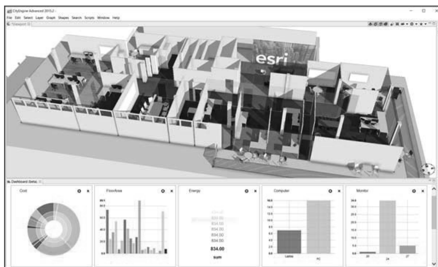
Figura 3. Modelo 3D de edificio con indicadores de consumo energético y costes de mantenimiento.
