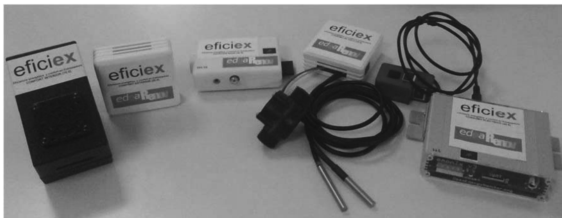
Figura 1. Sensores eficiex. De izquierda a derecha: Sensor de confort interior (temperatura, humedad y calidad del aire), Sensor de confort exterior (temperatura y humedad), estación base (Raspberry Pi), Sensor de consumo de agua-gas y sensor de consumo eléctrico.
