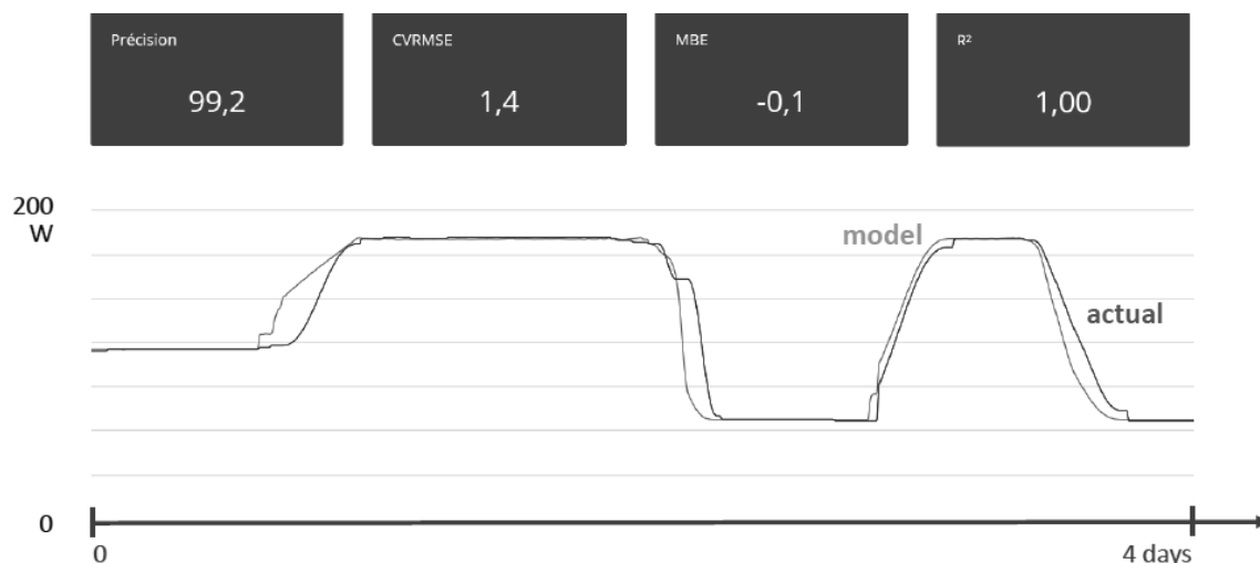
Figura 5. El modelo y la potencia real consumida por las máquinas virtuales están especialmente alineados en este caso. Si se hubiera utilizado un modelo de regresión lineal se habría degradado el resultado por un factor 5 para cada criterio.
