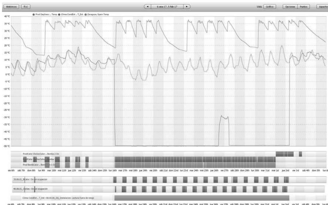
Figura 2. Señal de sensor de Temperatura exterior, On de bombas de primario/secundario e incidencias relacionadas.
