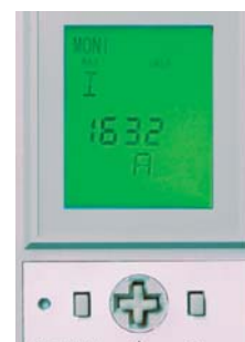
Tipo 3 Relé especial con pantalla LCD retroiluminada-Analizador de redes.
