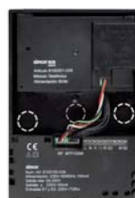
6 MÓDULO TELEFÓNICO + MÓDULO EMISOR RF GESTIÓN REMOTA TELÉFONO FIJO + SERVICIO LIBRE SIN HILOS (OPCIONAL)
