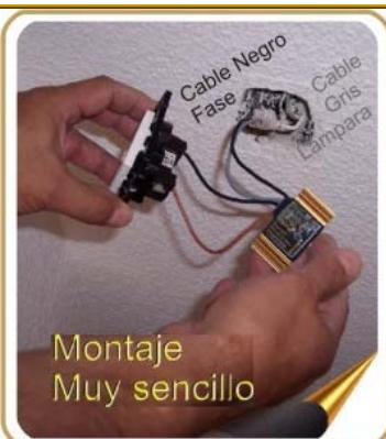
**Que es la Memoria de nivel y estado?**: Después de un corte de luz, sea cual sea la duración del mismo, el dimmer memoriza en una eeprom el último estado (si apagado o encendido) y el último nivel utilizado.
