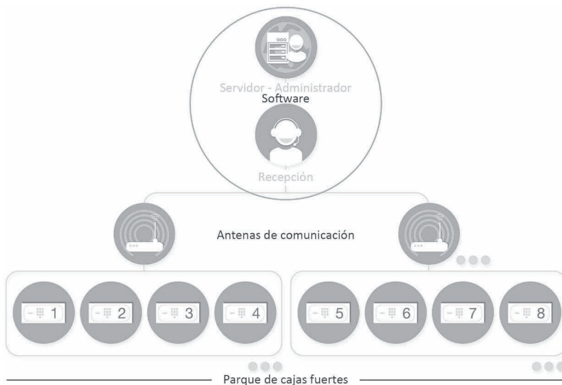
Figura 4. Esquema de comunicación del sistema iNET.
