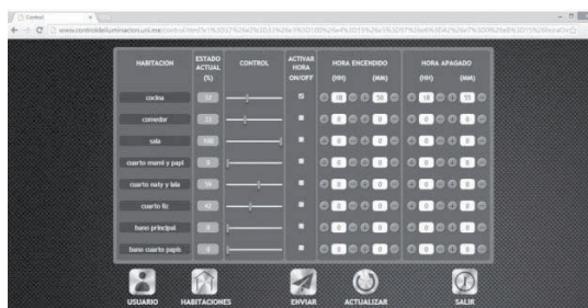
Figura 7. Servidor Web implementado para control de la iluminación domótica (Castillo&Montoya, 2014).
