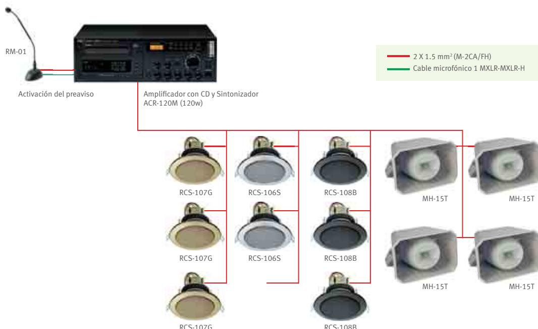
\* NOTA: La suma de los vatios de conexión de todos los altavoces nunca debe superar la potencia del amplificador que se instala.
