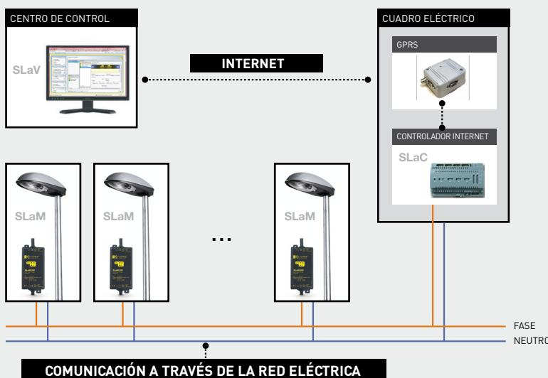
**El dispositivo SLaM-ON** se comunica con el cuadro eléctrico a través del cable de la red eléctrica existente. El cuadro incorpora el Controlador de Internet SLaC y un modem GPRS para comunicarse con el centro de mantenimiento, donde hay la aplicación software SLaV que informa del estado de las luminarias y alarmas en la instalación.
