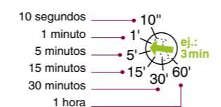
La temporización se puede ajustar a 10 s, 1 min, 5 min, 15 min, 30 min, 1 h, o en una posición intermedia (ej: 3 min).
