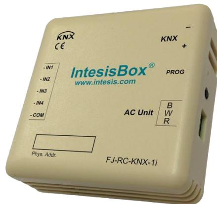
La pasarela dispone de conexión directa a KNX e incorpora 4 entradas binarias para contactos libres de potencial. Su programación se realiza de una forma fácil e intuitiva mediante ETS.
