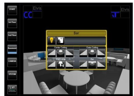
Bajo el punto de vista de la conectividad, Elvis 3 dispone ahora de comunicación directa con otros protocolos: OPC Server, Mod Bus, M-Bus, DLNA o IR Trans, entre otros, lo cual facilita sin duda la integración de KNX con otras funciones del edificio.
