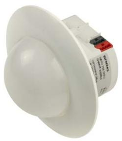
El modelo UP258/E11 es un detector con control de luminosidad integrado, diseñado para montaje en techo, con acoplador de bus integrado, con área de detección de 360°, puede ser operado a través de un mando IR y dispone de una salida para el control de climatización HVAC.
