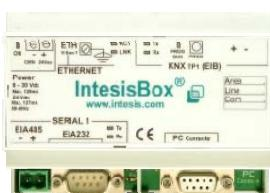
Con estos nuevos modelos, IntesisBox® ofrece una completa gama que permite una gran adaptabilidad a todo tipo de instalaciones, incluso aquellas con un número reducido de máquinas a controlar, permitiendo un control bidireccional completo de las unidades interiores de aire acondicionado de ambos fabricantes desde instalaciones KNX.
