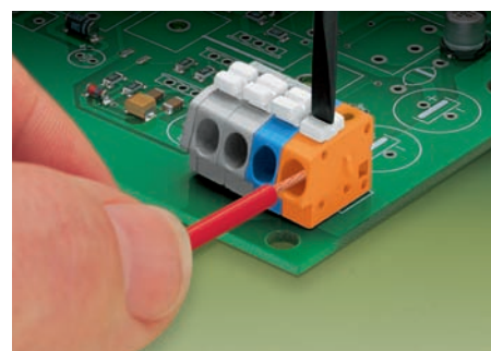
Conexión/Desconexión de un conductor flexible: Abrir el punto de conexión mediante la tecla de accionamiento e introducir el conductor pelado
