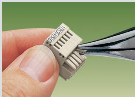
Codificación flexible del conductor hembra partiendo tetones
