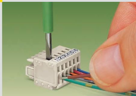
Conexión lateral del conductor – con destornillador (2,5 x 0,4) mm
