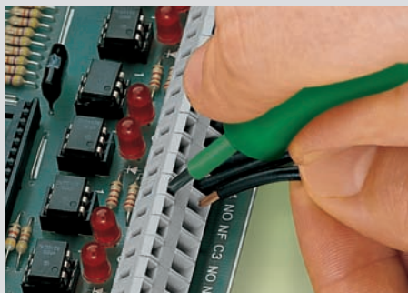
Conexión del conductor con destornillador 3,5 mm Accionamiento e introducción del conductor desde la misma dirección
