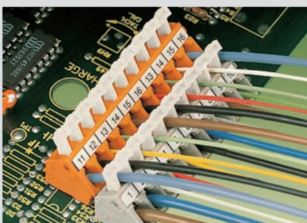
Posición de los conductores en el caso de regletas montadas una detrás de la otra de manera desplazada (sólo para la serie 256)
